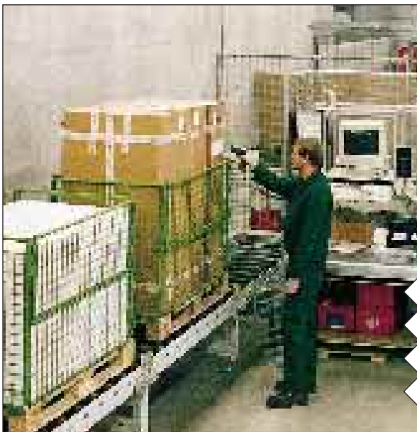
Palettenidentifikation und -einlagerung am I-Punkt
