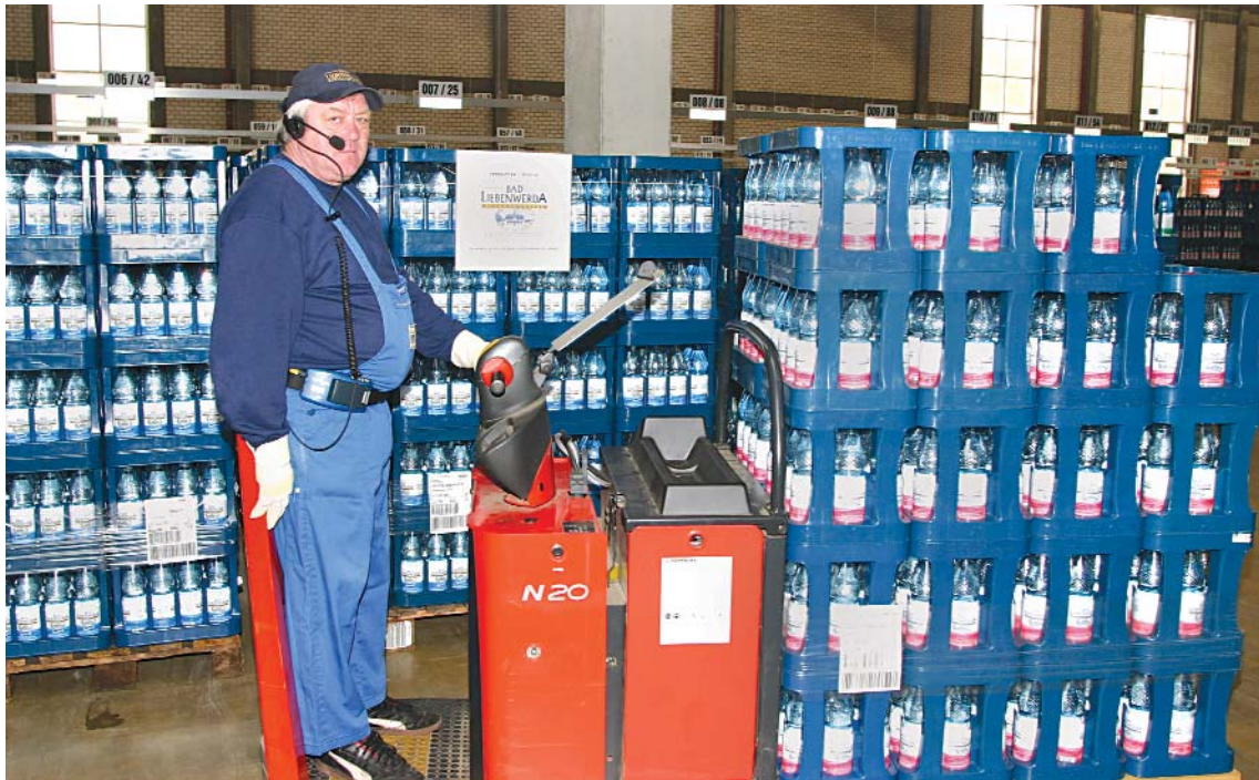
Entscheidend bei der Kommissioniertechnik Pick-by-Voice: Der Mitarbeiter hat beide Hände frei. Das ist besonders bei schweren Artikeln wie Getränkekisten von Vorteil..
