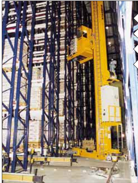
Eines von drei kurvengängigen Regalbediengeräten bei der Einlagerung einer Palette
